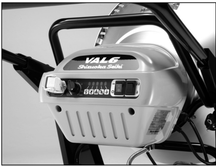
Desenrosque los dos tornillos y extraiga la cubierta del quemador.
