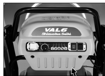
Temperatursensor für den internen Thermostat
